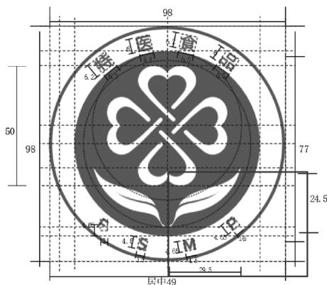
特医食品标志整体比例:98:98(高:宽),基本图案部分:77:77(高:宽)。花型图案比例:50:50(高:宽),中心位置于标识左右居中直径为62正圆中心处。叶子图案比例:24.5:61(高:宽),两叶片间距离2,叶片位置于基本图案的同心圆直径为69.5底齐,弧度基本保持一致,高度在基本图案黄金比例以下。单字比例:“特”高6.2,宽6.5;“医”高6,宽5.8;“食”高6.2,宽6.5;“品”高6,宽6.5;
